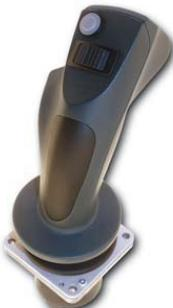
При заказе можно задать практически бесконечное количество опций – включая наличие фиксаторов положения, в том числе фрикционных, а также дополнительных выходов и переключателей. В качестве датчиков положения применяются датчики Холла или потенциометры. Рукоятку джойстика для своей системы можно выбрать из широкого ассортимента выпускаемых типовых рукояток или заказать компании разработку рукоятки по индивидуальным требованиям.
