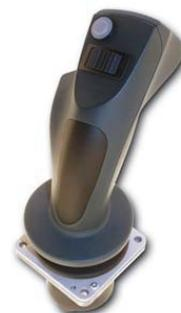
При заказе можно задать практически бесчисленное количество опций – включая наличие фиксаторов положения, в том числе фрикционных, а также дополнительных выходов и переключателей. В качестве датчиков положения применяются датчики Холла или потенциометры. Рукоятку джойстика для своей системы можно выбрать из широкого ассортимента выпускаемых типовых рукояток или заказать компании разработку рукоятки по индивидуальным требованиям.
